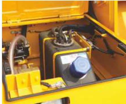
POMPA NAPEŁNIANIA PALIWA
