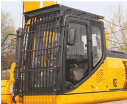
SYSTEM FOPS I OCHRONA PRZED ODŁAMKAMI
